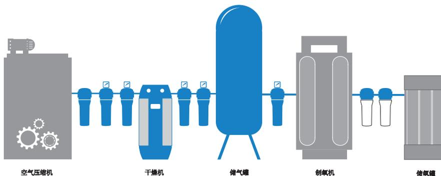
上图是典型的制氧设备安装流程图，包括制氧机前端的压缩空气过滤器和后端的氧气过滤器。
